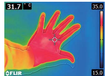
スギ材を触ると手の温度は32°Cに変化
